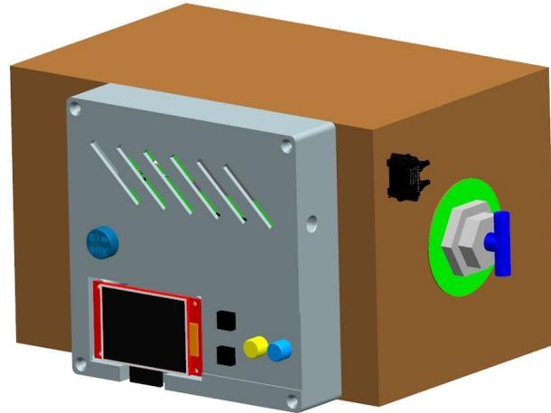
*Infraschall-Messgerät: Druckkörper (braun) mit montiertem 3D-Druck-Gehäuse (grau) mit eingelassenem Display (rot). Grafik: privat*
